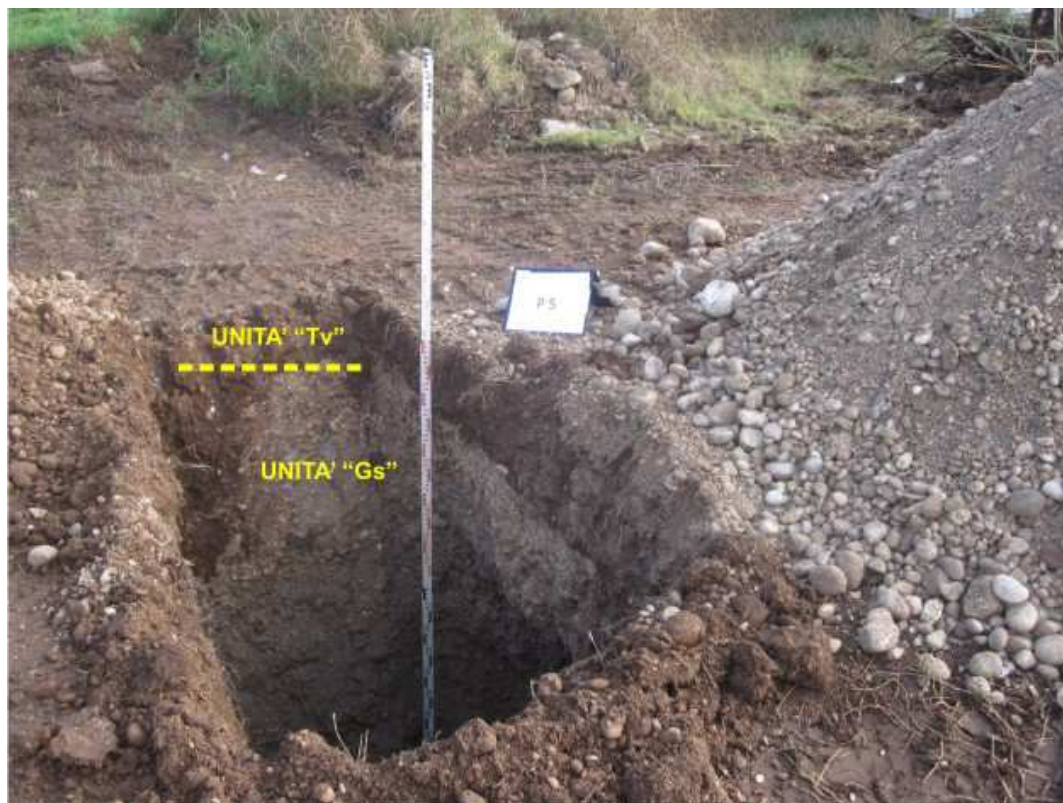
Modello stratigrafico "tipo" evidenziato sul fronte di una delle trincee eseguite
